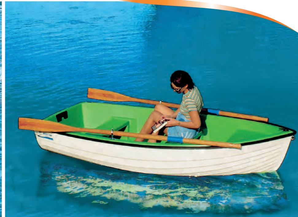
🇮🇹 Il limitato peso (60 kg circa) e la linea poco ingombrante di questa lancetta, permettono un facile trasporto anche sul tetto della macchina; costruita in doppia scocca con ampio gavone di prua; specchio di poppa già attrezzato per l'inserimento di un eventuale motore F.B.
