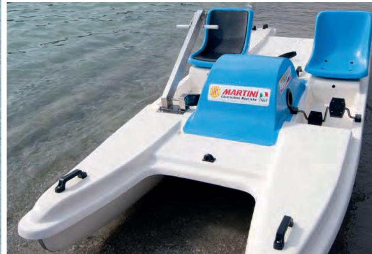
🇮🇹 Il dispositivo per la "pedalata manuale" brevettato. Divertimento, sport e tempo libero accessibili a tutti. Sport, divertimento e mare accessibili a tutti! Questo particolare dispositivo da noi brevettato permette di trasmettere la forza motrice anche o addirittura solo con le braccia. Perfetta per lo sport all'area aperta e per competizioni sportive!
